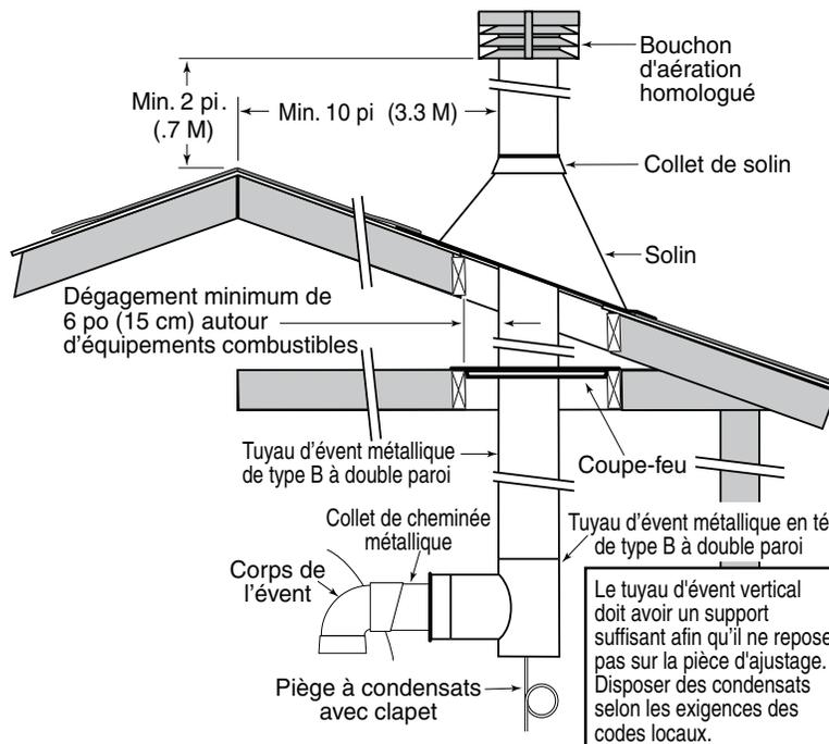
**Figure 18.** – L'installation de tuyau de conduit en métallique typique - Canada.
