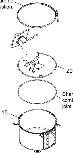
Chambre de combustion joint torique
