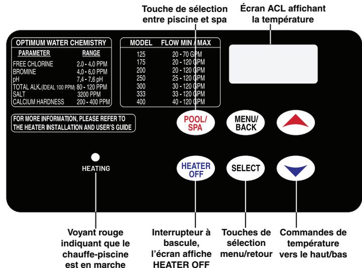
Figure 42. Panneau de commande du chauffe-piscine
