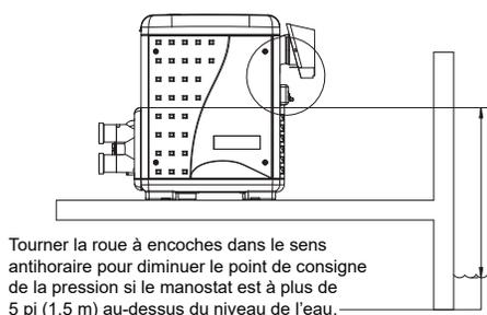
Tourner la roue à encoches dans le sens antihoraire pour diminuer le point de consigne de la pression si le manostat est à plus de 5 pi (1,5 m) au-dessus du niveau de l'eau.
