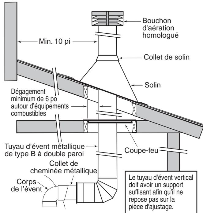
**Figure 12.** – L'installation de tuyau de conduit en métallique typique - É.-U.
