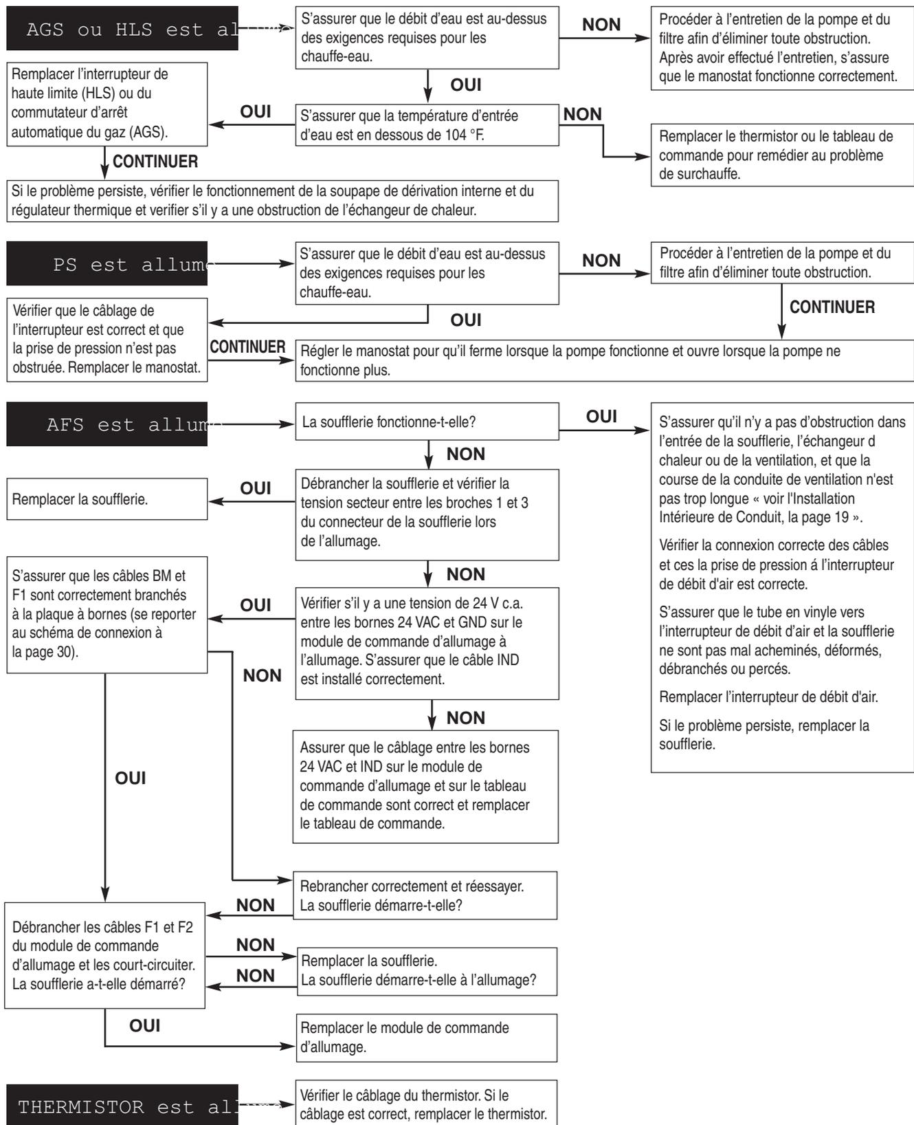
**ATTENTION** Ne pas court-circuiter un interrupteur de sécurité pour remédier à un interrupteur défectueux.
