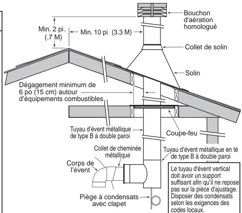
**Figure 13.** – L'installation de tuyau de conduit en métallique typique - Canada.
