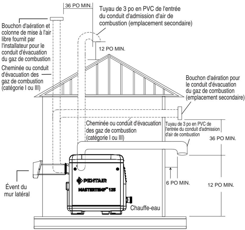
**Exigences du tuyau de 3 po en PVC de l'entrée du conduit d'admission d'air de combustion\***
