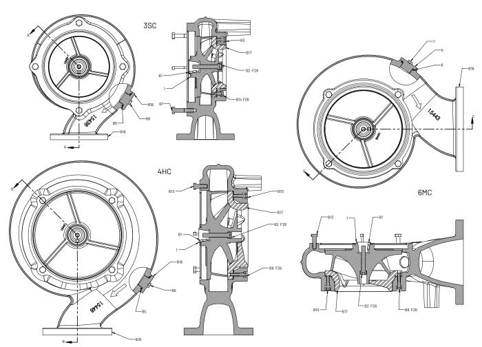
TYPICAL: GAP BETWEEN LINER(B17) AND IMPELLER(1) TO BE SET AT .008-.015" FROM FACTORY
